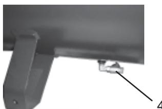
*Válvula de dreno de condensados*
