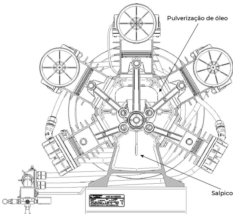
Figura 9 - Lubrificação interna
