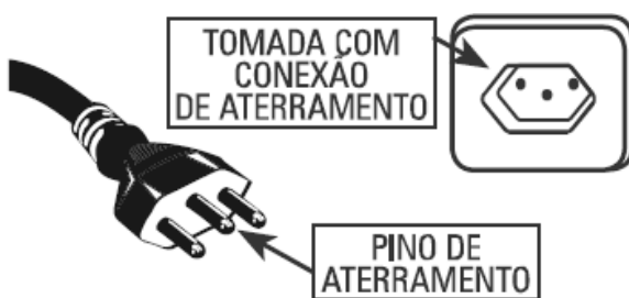
FIGURA 3 - CONEXÃO DO PLUG A TOMADA (MONOFÁSICO)
